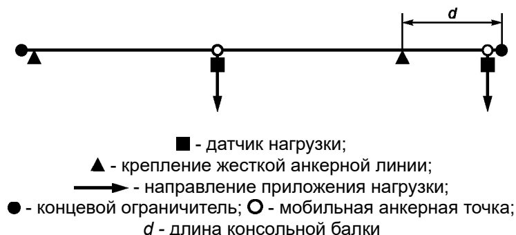
Рисунок 19 - Образец испытательной конфигурации анкерного устройства типа D с консольной балкой
