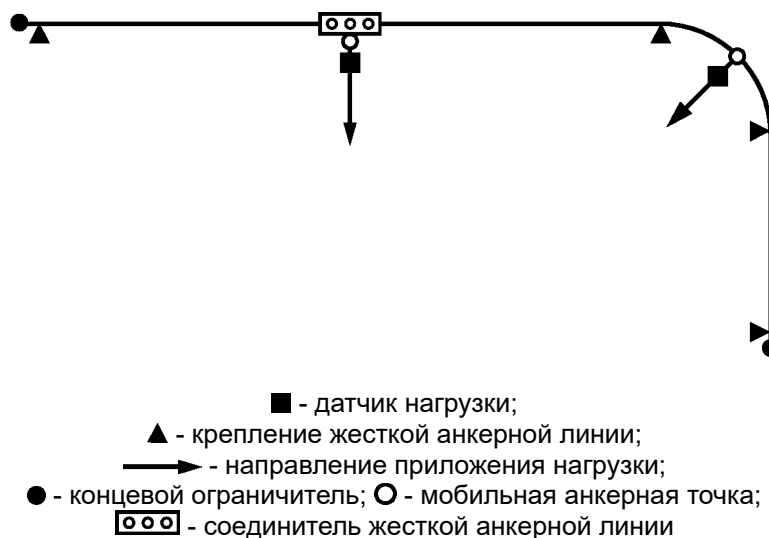
Рисунок 20 - Образец испытательной конфигурации анкерного устройства типа D, содержащей соединение жесткой анкерной линии и угловой анкер
