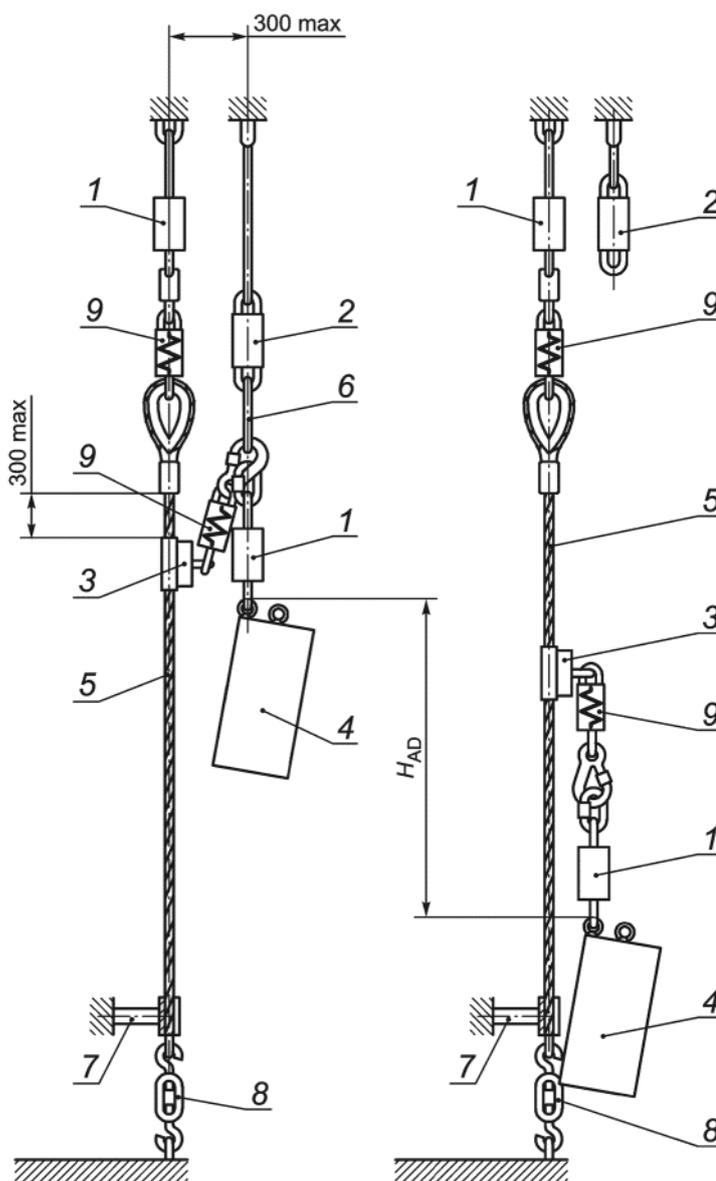
$H_{AD}$  - страховочный участок; 1 - устройство измерения нагрузки; 2 - устройство быстрого расцепления; 3 - средство индивидуальной защиты от падения с высоты ползункового типа; 4 - жесткий испытательный груз; 5 - жесткая анкерная линия; 6 - соединительный канат; 7 - направляющий элемент; 8 - устройство предварительного натяжения; 9 - поглощающая энергию деталь (при наличии)
