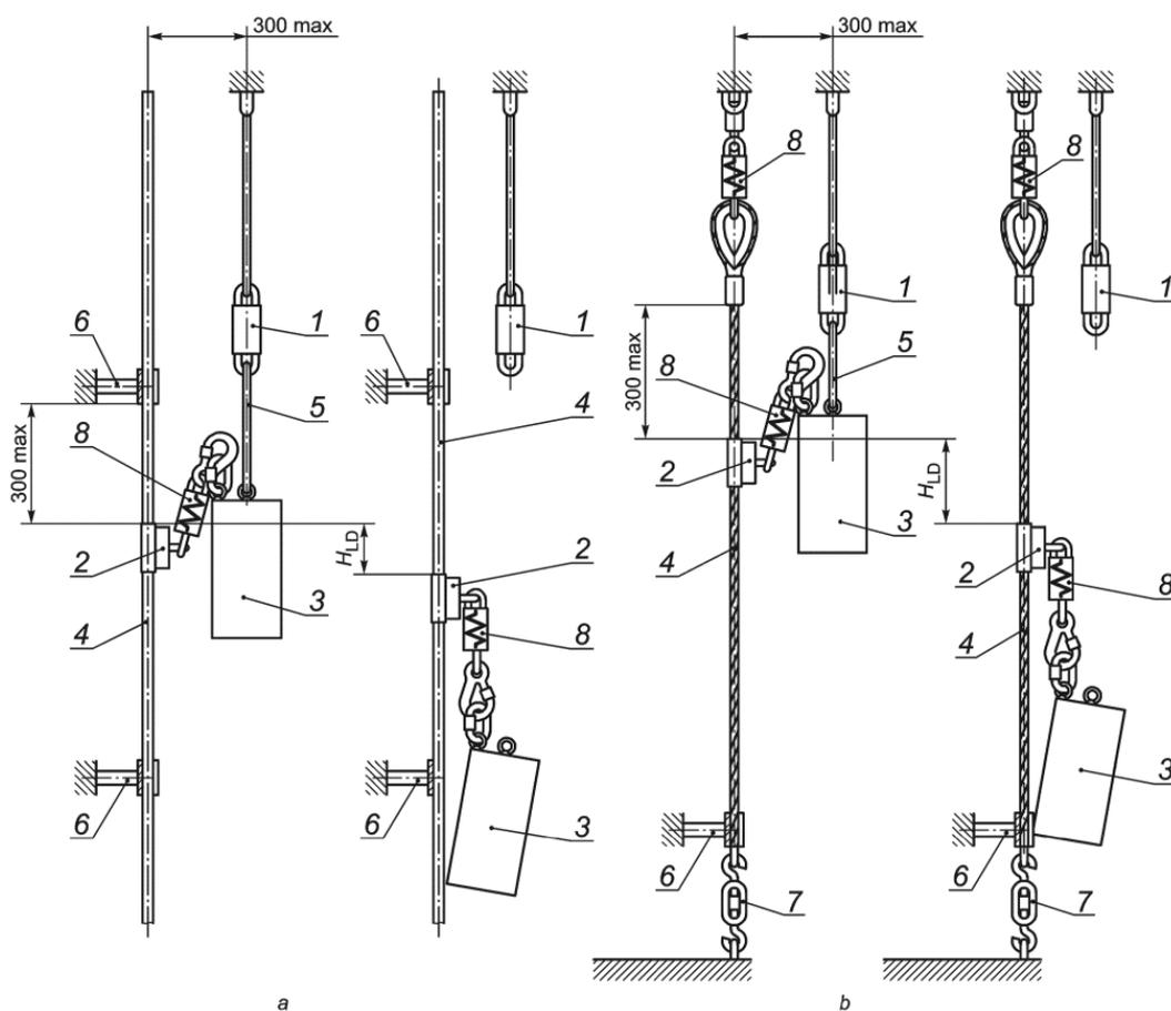
$H_{LD}$  - участок торможения; 1 - устройство быстрого расцепления; 2 - средство индивидуальной защиты от падения с высоты ползункового типа; 3 - жесткий испытательный груз; 4 - жесткая анкерная линия; 5 - соединительный канат; 6 - элемент крепления или направляющий элемент; 7 - устройство предварительного натяжения; 8 - поглощающая энергию деталь (при наличии)
