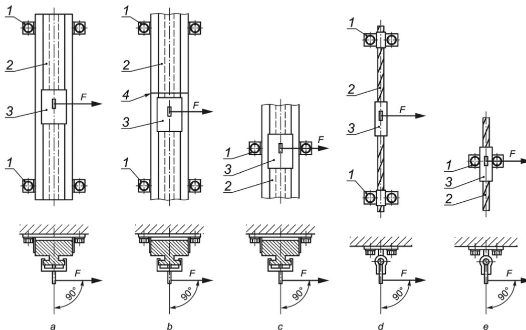
$F$  - статическая нагрузка; 1 - элемент крепления или направляющий элемент; 2 - жесткая анкерная линия; 3 - средство индивидуальной защиты от падения с высоты ползункового типа; 4 - соединитель рельсовых сегментов
